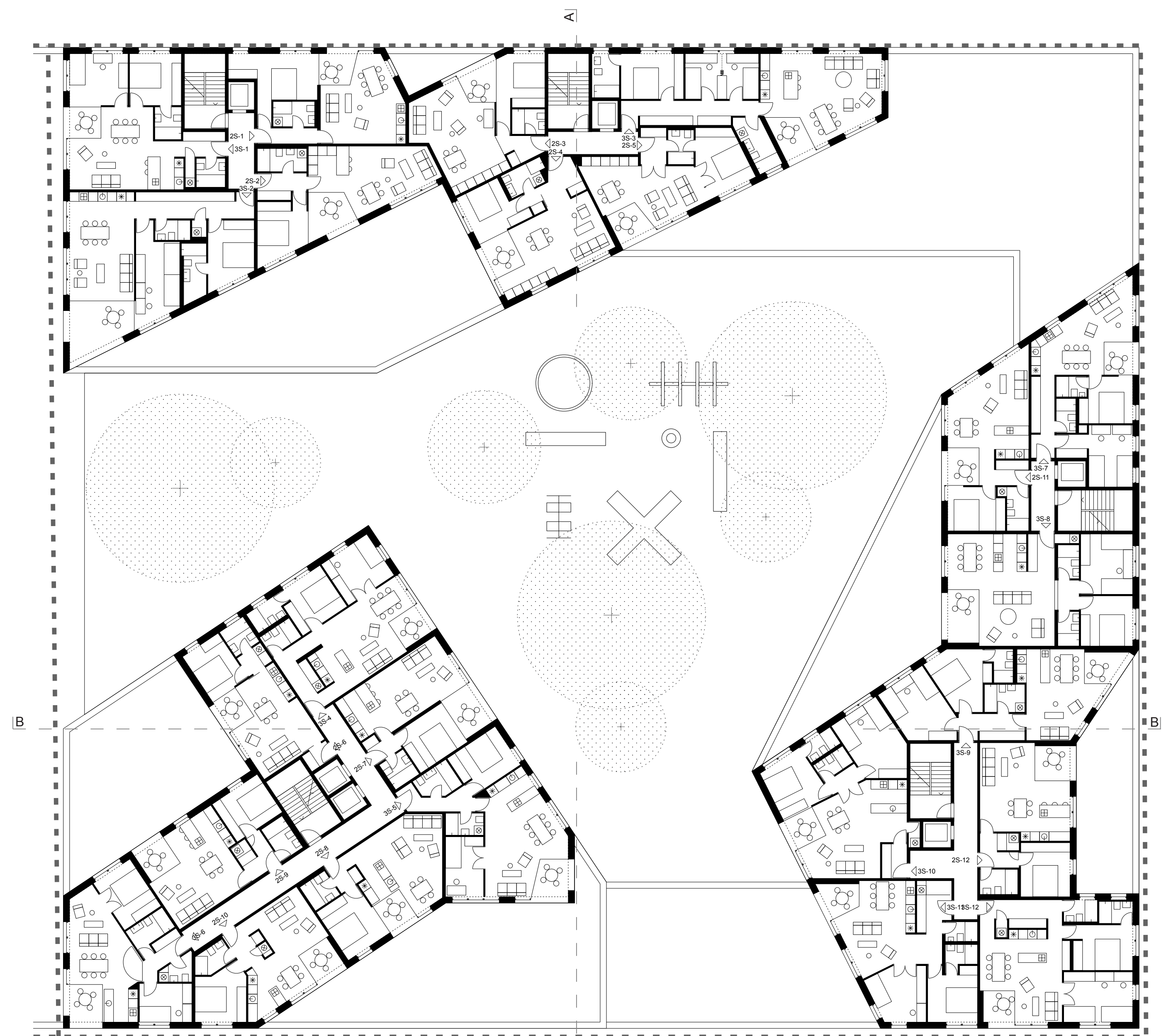
Tlocrt 3., 5. i 7. kata - stambene etaže
